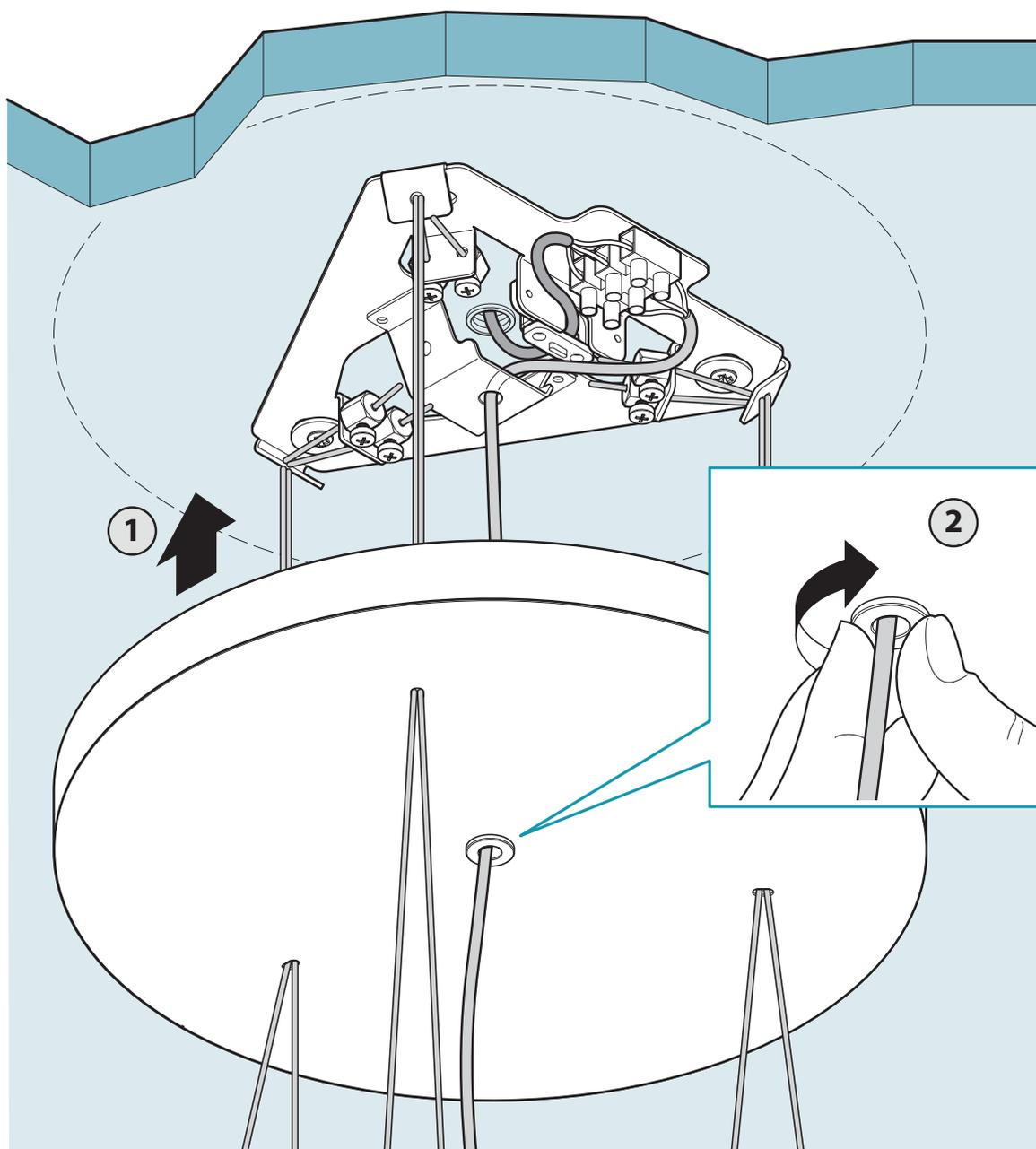
IT - Bloccaggio cavi di sostegno (7).
